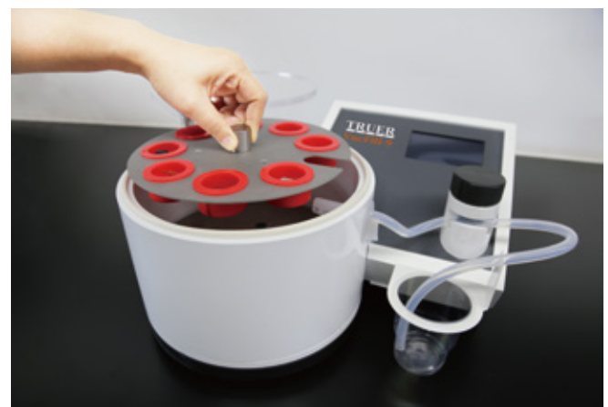
模具杯架轻松固定镶样模具，可稳固取出，开始新一轮真空操作
